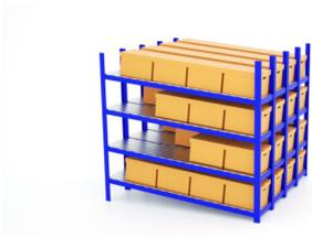
Durchlaufregale werden häufig in Verteillagern zur Kommissionierung verwendet. In den Regalen lagern mittlere Artikelmen­gen bei kleiner bis mittlerer Artikelanzahl. Dieses System arbeitet nach der FiFo-Methode. Über Rollenbahnen rückt die eingelagerte Ware selbsttätig zur Entnahmestelle vor. Dadurch wird gewährleistet, dass im Durchlauf­lager nichts veraltet.
